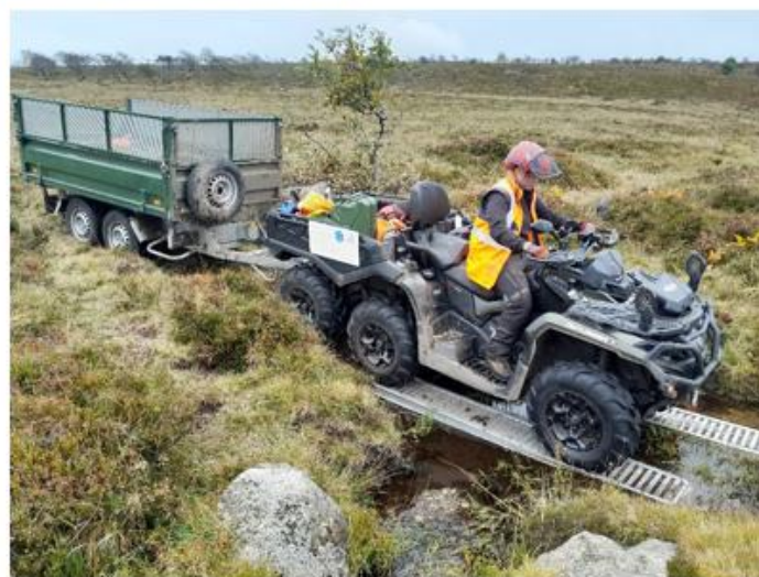
Matériel de franchissement des cours d'eau
